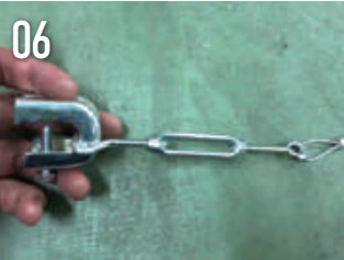
反対側のパイラックをセット
